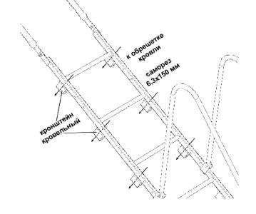
6 Закрутите саморез 6,3х150 мм в обрешётку кровли через отверстия в полотне лестнице, кровельном кронштейне и EPDM резиновом уплотнителе и кровельном полотне.
